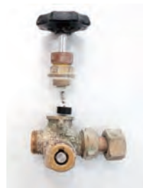
老朽化した止水栓
